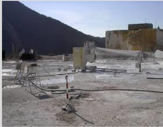
Tagliatrice a filo diamantato: marmettola dispersa ovunque
