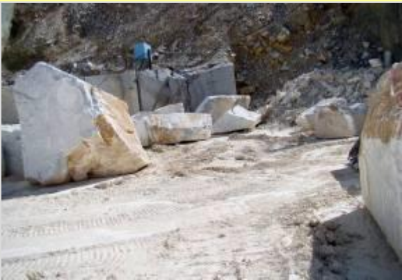
Marmettola su piazzale
