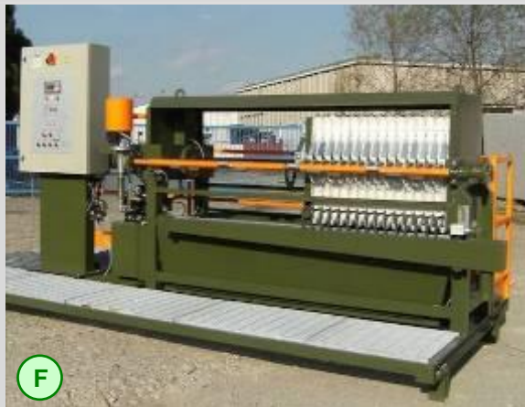
Esempio di trattamento più efficiente: filtropressa
