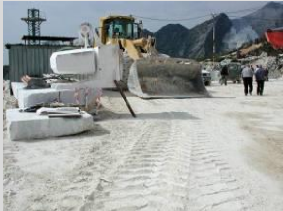
Marmettola su piazzale
