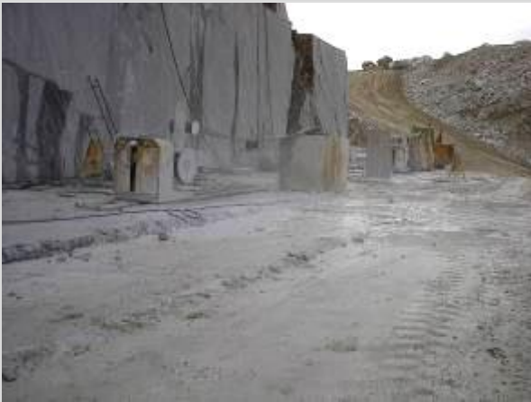
Tagliatrice a filo diamantato: marmettola dispersa ovunque
