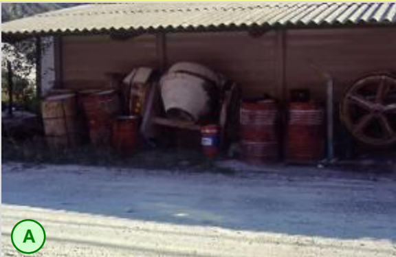
Stoccaggio oli senza accorgimenti di prevenzione da perdite
